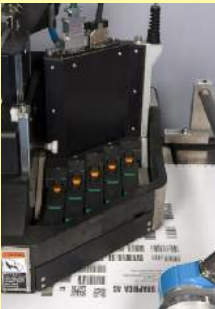
Die Inkjet-Druckmodule IPAS 425 i lassen sich sowohl einzeln als auch gesticht einsetzen.
